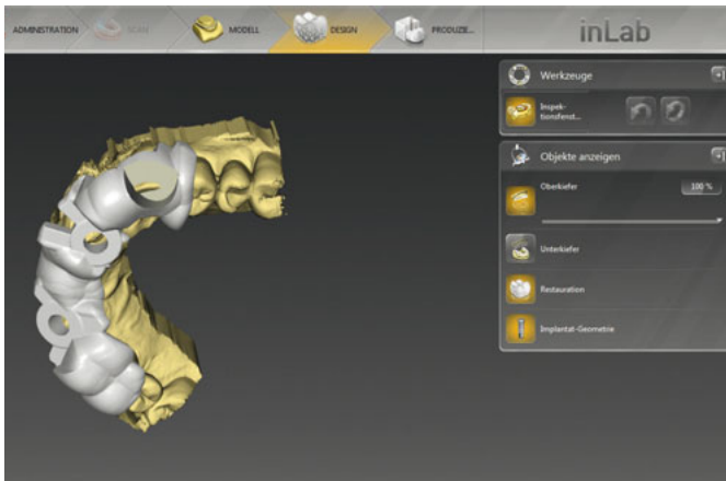
Abb. 11 Im Inspektionsfenster werden Positionen und Angulationen kontrolliert.
