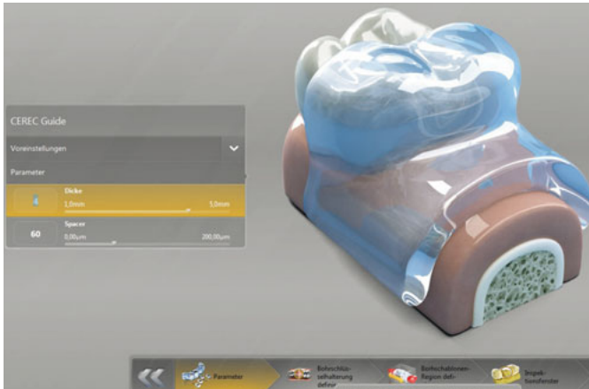
Abb. 19 Die Software gibt dem Anwender die Möglichkeit, die Größe der Auflagefläche zu variieren und Durchdringungen des Kiefers mit der Bohrhülse zu korrigieren.
