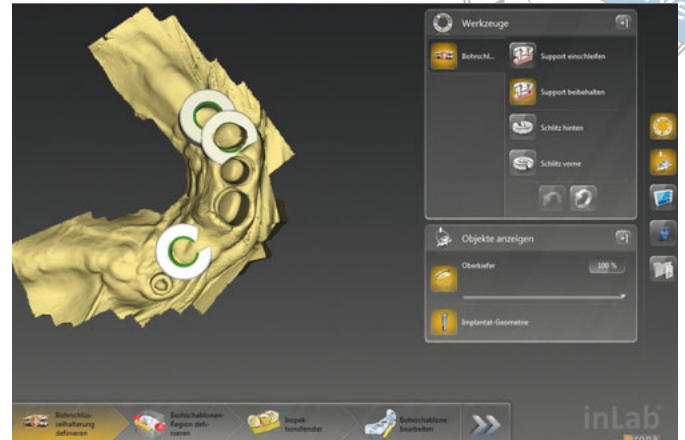
Abb. 20 Die Bohrschlüsselhalterung wird definiert und dabei gegebenenfalls in ihrem Durchmesser angepasst.
